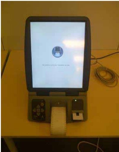
Système de vote combiné avec écran tactile et urne équipée d'un scanner (Belgique)
